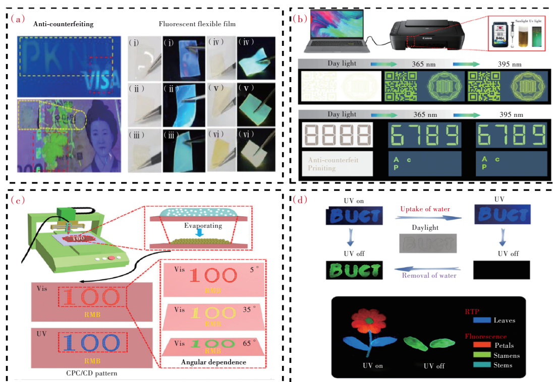
图9 (a)废纸基 CDs 制备荧光柔性薄膜的防伪应用 [82] ; (b)碱木质素基 CDs 的打印防伪应用 [83] ; (c)基于三维微流控打印技术的多信号防伪胶体光子晶体/龟壳 CDs 图案薄膜构建示意图 [84] ; (d) CDs 聚集诱导发射和超长室温磷光防伪示意图 [85] 。
